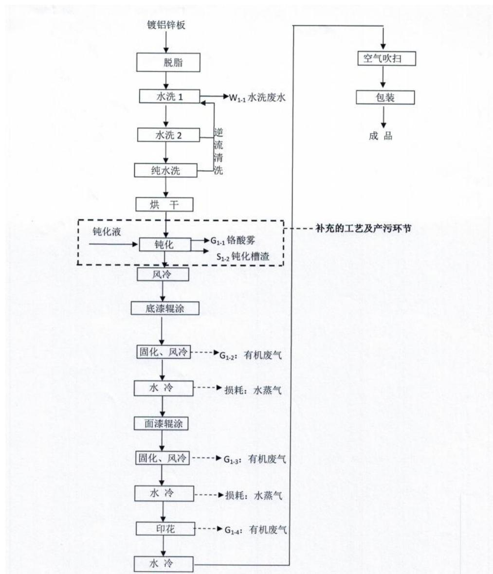
图3.2-3 彩涂板工艺流程图
