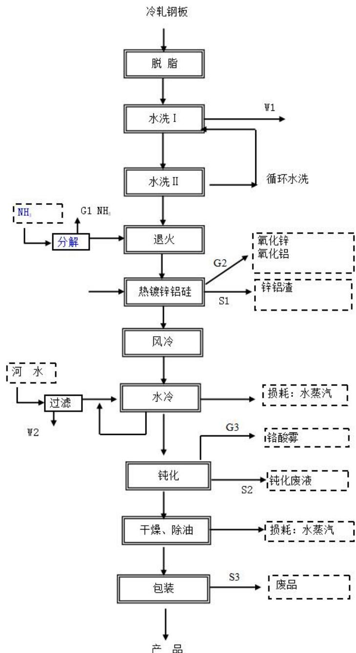
图 4.5-1 热镀铝锌硅板生产工艺流程图
